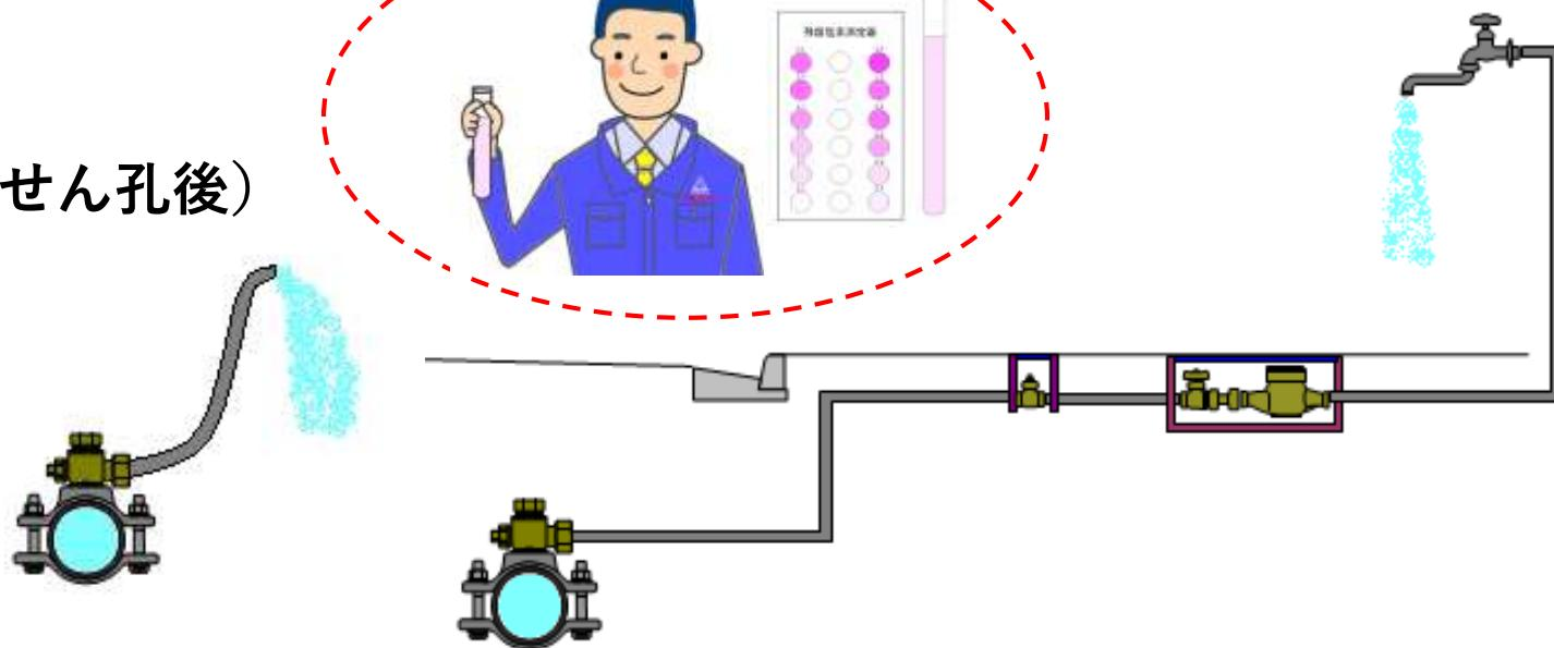
※ 残留塩素濃度の測定は、取出し工事の際には分岐部において、工事完了後は末端給水栓において行い、水道水であることを確認する。
