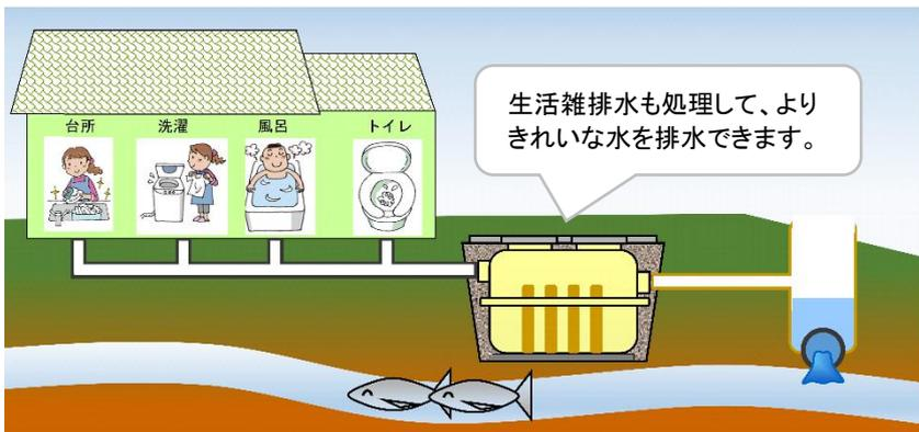
トイレの排水と生活雑排水(台所、風呂、洗濯、洗面台などの排水)を併せて処理します。浄化槽を新たに設置するときは、合併処理浄化槽の設置が義務付けられています。
