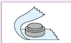
安全のため、電池1個ずつを図のようにセロテープでの絶縁をお願いします。
