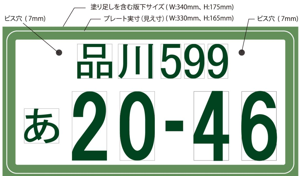
■ 中型標板（事業用） 後部ナンバープレート（封印×1ヶ所、ビス穴×1ヶ所）
