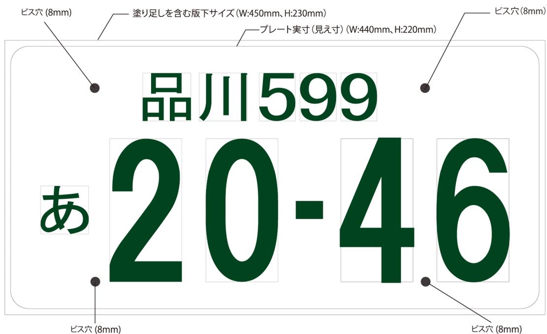
■ 大型標板（自家用） 後部ナンバープレート（封印×1ヶ所、ビス穴×3ヶ所）
