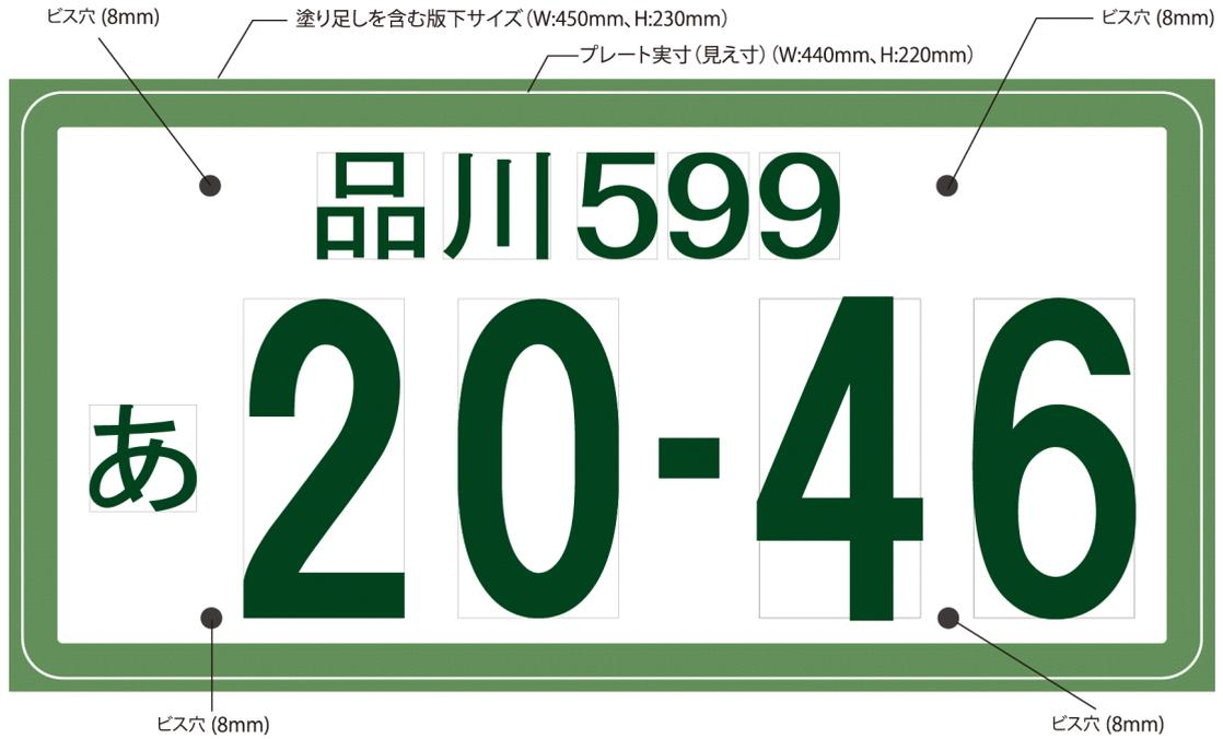
■ 大型標板（事業用） 後部ナンバープレート（封印1ヶ所、ビス穴×3ヶ所）
