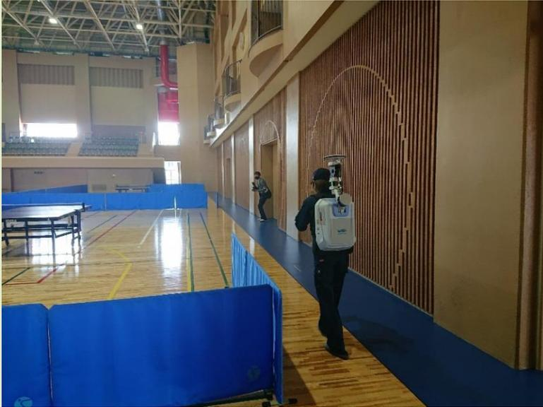
新型コロナウイルス等感染症リスク軽減対策のため、避難所施設の3次元計測及び空気・粒子の流れのシミュレーション試行
